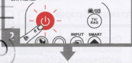
Расположите передатчик оригинального пульта дистанционного управления передней стороной к передатчику этого пульта дистанционного управления и держите расстояние от 1 до 3 см, не передвигая пульты. Нажмите кнопку POWER («ПИТАНИЕ») на пульте оригинального дистанционного управления, индикатор быстро мигнет 3 раза, а затем он будет продолжать гореть, это означает, что программирование прошло успешно. Повторите шаги 2 и 3, чтобы запрограммировать другие кнопки или выполнить программирование снова.
