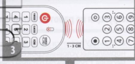
По завершении программирования нажмите и удерживайте кнопку OK в течение 3 секунд, чтобы выйти из режима программирования. Индикатор погаснет, запрограммированные функции сохранятся и пульт выйдет из режима программирования.
